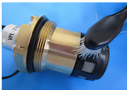
7. ブラシ等でストレーナを清掃します。ストレーナに破損が無いかご確認ください。 清掃、再設置後は止水栓の開栓を忘れないでください。
